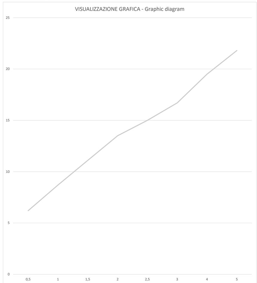
Note: Scarico libero - portata di ogni singola uscita del deviatore
